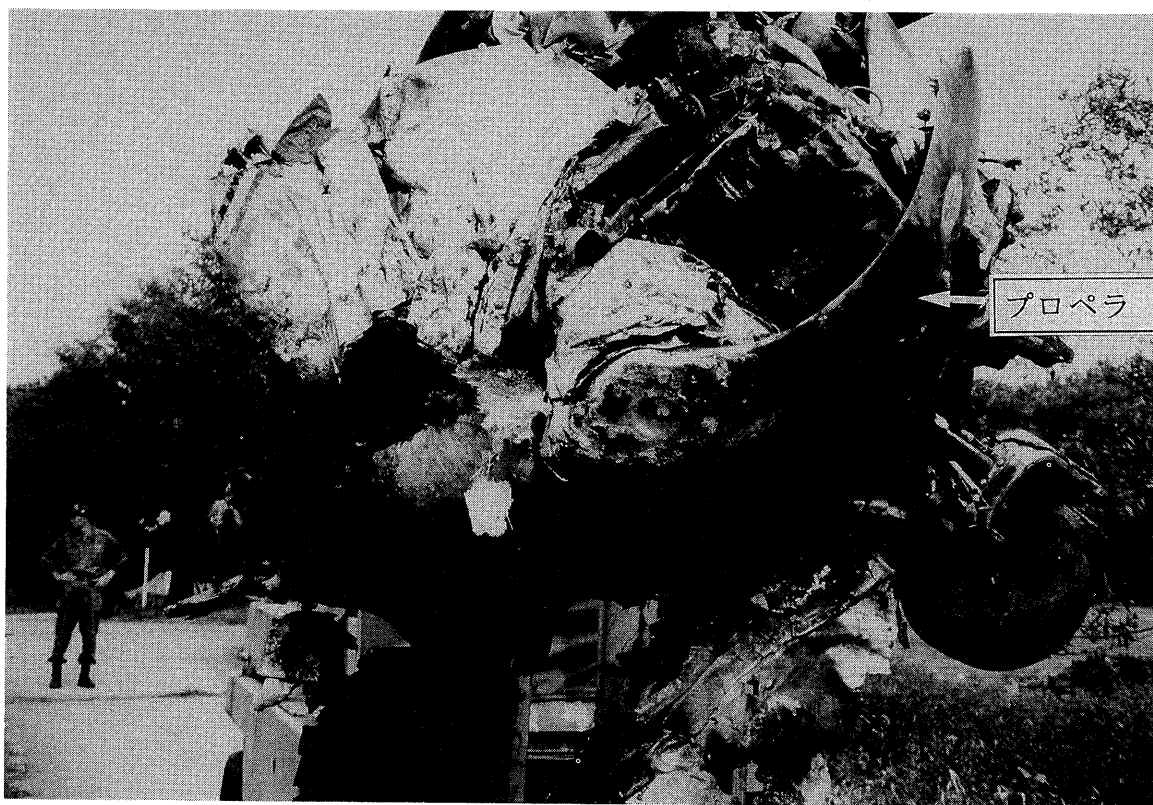
写真 1 - 3 掘り起こされた機首部 (A機)
